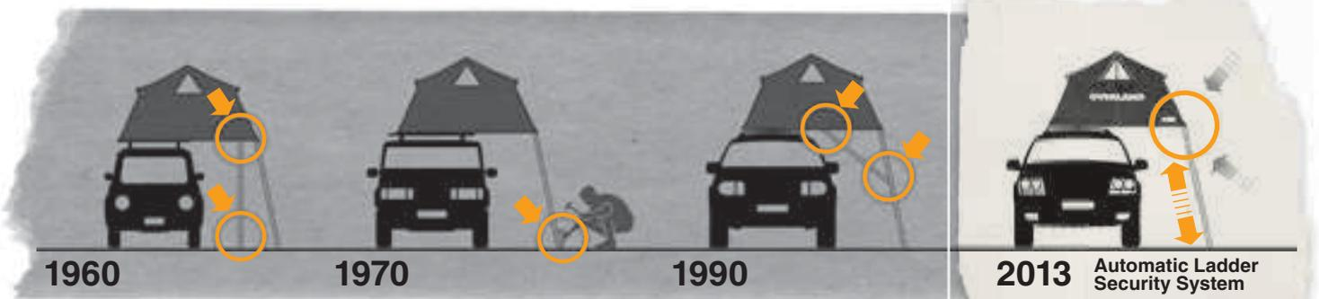
Das Zelt wird durch zusätzliche Teleskopstangen abgestützt.
