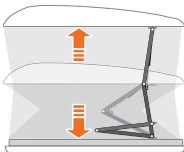
Nach dem Lösen der Verschlüsse heben die integrierten Gasfedern die Oberschale automatisch bis zur vollständigen Öffnung an.
