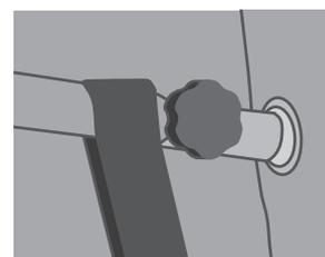
Zwei Bänder wurden in die Struktur integriert. Sie fixieren den Eingang vor dem Einstieg ins Zelt, damit kein "Segel Effekt" (Aufschlagen bzw. Flattern des Stoffes) entsteht.
