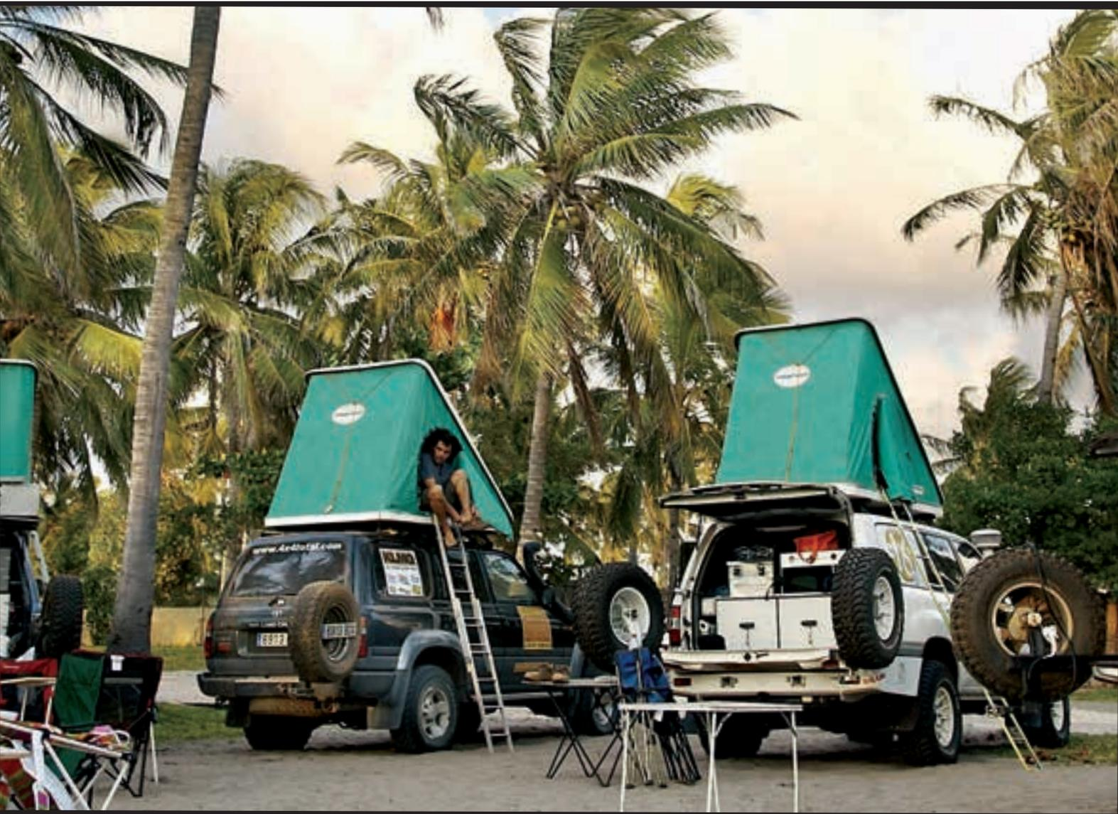
Die Columbus Serie ist mit einer sich selbst öffnenden Gasfeder-Automatik ausgestattet. Nach Öffnen des hinteren Verschlusses wird die obere Dachschale durch die beiden Gasfedern aufgerichtet und der Zeltstoff straff gespannt.
