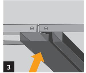
**3** - Die Scharnier-Struktur besteht aus speziellen integrierten Profilen, die dem Boden eine sehr hohe Querfestigkeit verleihen.
