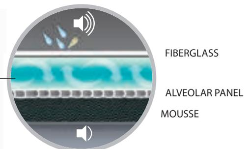
Der neue Dachhimmel mit Mehrschicht-Isolierung, exklusiv bei Autohome. Dank eines Luftpolsters, welches durch eine Hohlkammerplatte gebildet wird und einer isolierenden Schaumschicht, erhält man einen sehr guten Lärm- und Wärmeschutz ohne Gefahr von Kondenswasserbildung. Angenehmer, wärmer und leiser selbst bei Hagel!
