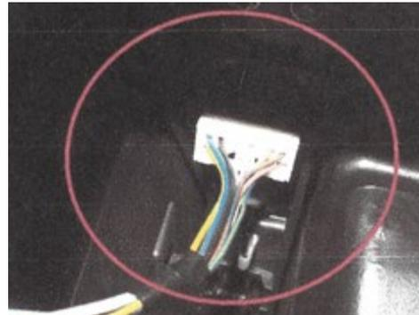
Entfernen Sie den Stecker von der Rückseite des Spiegelschalters.
