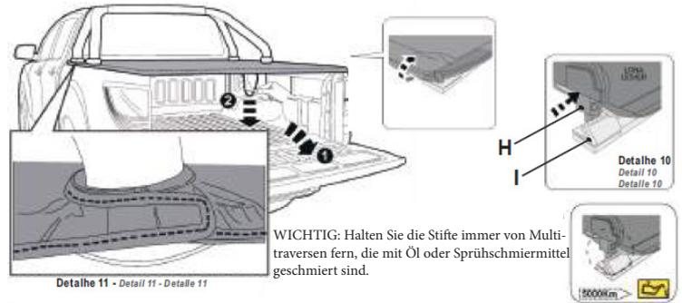
**Schritt 13:** Rollabdeckung „A“ nach innen zur Vorderseite des Fahrzeugs rollen und mit den Schnüren sichern.
