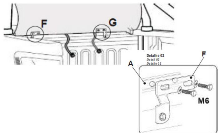
**Schritt 5:** Richten Sie das vordere Profil mit der konturierten Vorderseite des Überrollbügels aus. Positionieren Sie das vordere Profil „A“ zwischen der Kabine und dem originalen Überrollbügel des Fahrzeugs. Drücken Sie das vordere Profil „A“ nach unten und ziehen Sie die Schrauben in den vorderen Halterungen „F“ und „G“ an.
