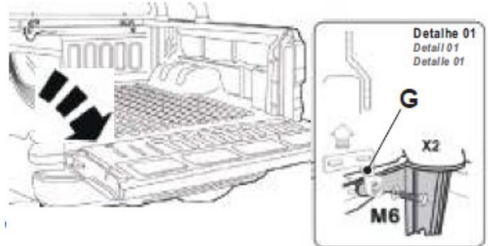
**Schritt 4:** Richten Sie die Montagebefestigungen in der Softcover-Schiene „A“ mit den oberen Löchern der vorderen Klemmstücke aus und setzen Sie die Schrauben M6 ein und ziehen Sie sie von Hand an. Hinweis: Ziehen Sie die Schrauben zu diesem Zeitpunkt noch nicht an, da die Befestigungselemente nach der Montage der Seitenprofile angepasst werden müssen.
