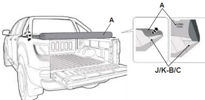
**Schritt 11:** Um die Abdeckung zu öffnen, befindet sich die Entriegelungslasche unter der mittleren Rückseite der Abdeckung. Ziehen Sie diese nach unten, um die Verriegelungen zu lösen. Drehen Sie die hintere Schiene nach oben, um die Verriegelungen vollständig zu lösen (Detail 10). Lösen Sie den Klettverschluss am Überrollbügelrohr (Detail 11).
