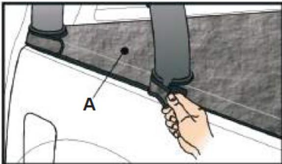
**Schritt 12:** Arbeiten Sie von der Rückseite der Abdeckung „A“ aus und heben Sie sie nach oben, um die flexible Flansche von den Seitenschienen zu lösen.
