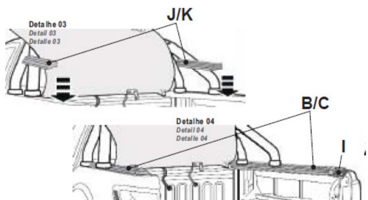
**Schritt 8:** Positionieren Sie den Querträger front „E“ zwischen den Seitenschienen „J“ und „K“ und den Querträger Heck „E“ auf den Seitenschienen „B“ und „C“, wie durch die Aufkleber auf den Profilen (Detail 06) angegeben.
