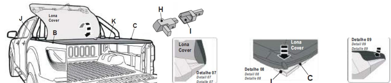
**Schritt 6:** Positionieren Sie die Seitenschienen „J“ und „K“ auf der Mulde zwischen den Konturen des Überrollbügels. (Detail 03).
