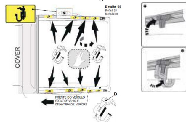
**Schritt 9:** Ziehen Sie die Abdeckung zum Heck des Fahrzeugs hin hoch.
