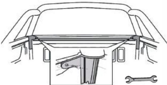
**Schritt 3:** Rollen Sie die Plane ab und positionieren Sie das vordere Profil vor dem Laderaum. Legen Sie die Abdeckung auf die obere Vorderseite der Fahrzeugkabine und lassen Sie diese während der anderen Montagen dort. Stellen Sie sicher, dass sich die Befestigungsbänder im Laderaum befinden.
