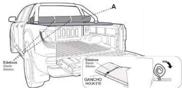
**Schritt 14:** Stellen Sie sicher, dass alle Seiten der Abdeckung verriegelt sind, um das Zubehör nicht zu beschädigen.
