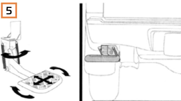
5 Prüfen Sie die Hecktrittstufe bei eingefahrenem Zustand.
