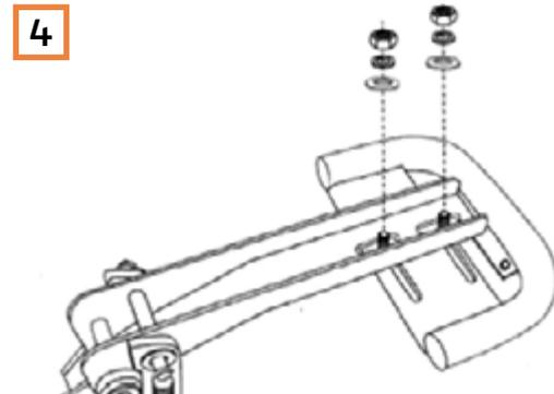
4 Befestigen Sie nun die Trittstufe (Mutter M10, Federring, Beilagscheibe). Muttern mit max. 10 Nm anziehen.
