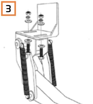
3 Befestigen Sie die Halterung wie abgebildet (verwenden Sie hierfür die Schrauben M10x30, Beilagscheibe, Federring und Mutter. Mit max. 30 Nm festziehen.
