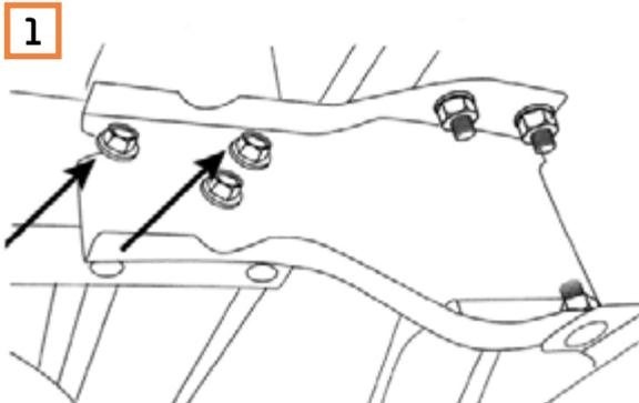
1 Entfernen Sie bei dem hinteren Stoßfänger die Schrauben.
