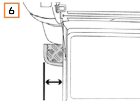
6 Stellen Sie sicher, dass der seitliche Platz von Ihrer Hecktrittstufe ihnen einen sicheren Stand bei abge- senkter Heckklappe bietet.
