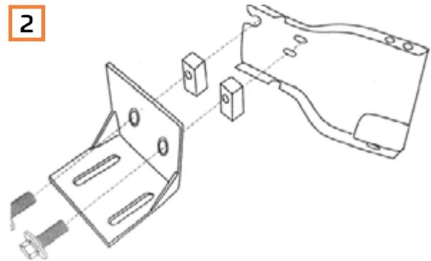
2 Montagehalterung anbringen (verwenden Sie hierfür die Schrauben M 10x60 und Beilagscheiben). Mit max. 80 Nm festziehen.
