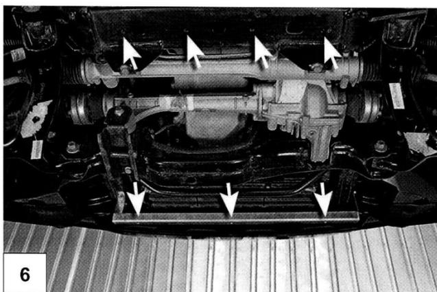
6 Befestigungspunkte Schutzplatte
