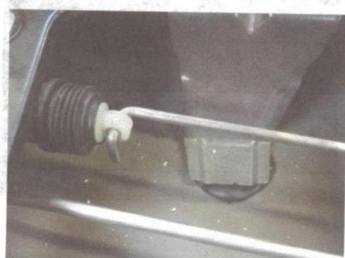
6. Entfernen Sie das original **Schloss-Gestänge** aus dem Fahrzeug.
