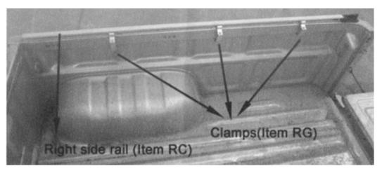
Legen Sie die rechte Längsträger (RC) und die linke Längsträger (RB) auf jede Seite der Ladefläche. Stecken Sie die Klemmen (RG) in die inneren Nuten der Längsträger. Verteilen Sie die Klemmen auf jeder Seite der Abdeckung gleichmäßig (siehe Bild). Ziehen Sie die Klemmen mit dem Inbusschlüssel lose an.
