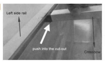
Ziehen Sie dann die Klemmen mit dem Inbusschlüssel an den Seitenschienen fest an. Setzen Sie die Deckelarmbrüste (RD, RE, RF) in die Nuten der Gleitschienen ein, wie im Bild unten gezeigt. Die Position der Bögen wird durch Ausschnitte in der Schiene definiert.
