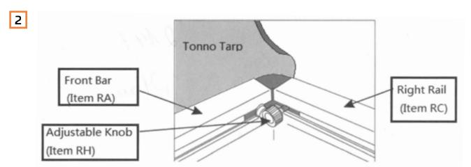
Stecken Sie den Frontbügel (RA) in die beiden Seitenschienen (RB und RC) und ziehen Sie die Knöpfe (RH) fest. Achten Sie auf die Position der Knöpfe im Bild unten.
