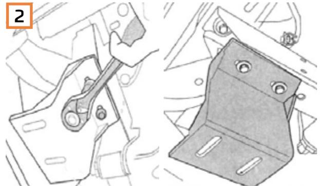
2 Befestigen Sie den Montagewinkel mit dem Schraubenset 6 (Schraube M10x30, Federring, Unterlegscheibe) am Hohlträger und der darunterliegenden Sicherungsplatte.
