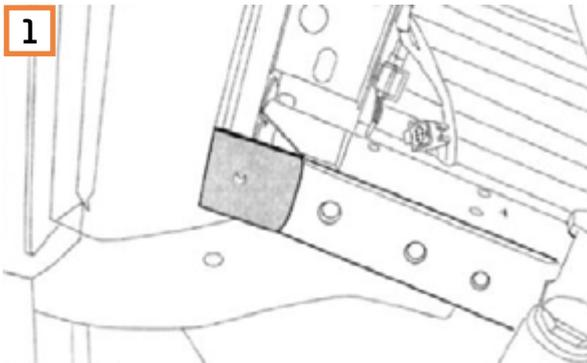
1 Schieben Sie die Sicherungsplatte in den Hohlträger bis die Löcher bündig sind.
