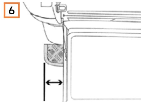
6 Stellen Sie sicher, dass der seitliche Platz von Ihrer Hecktrittstufe Ihnen einen sicheren Stand bei abgeenkter Heckklappe bietet.
