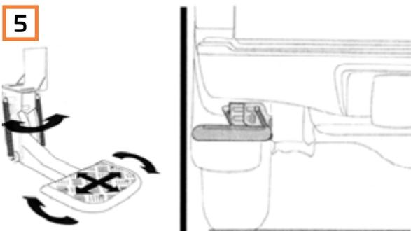
5 Prüfen Sie die Hecktrittstufe bei eingefahrenem Zustand.
