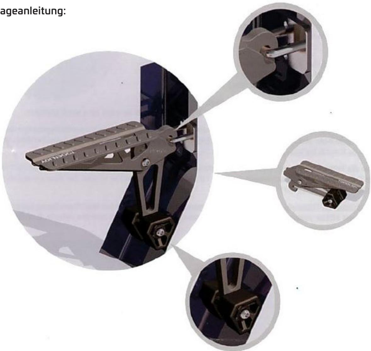
Trittstufe wie abgebildet einhängen. Den Sechskant Gummipuffer so ausrichten, dass die größtmögliche Gummifläche auf den Türrahmen liegt (Punktuelle Belastung durch den Gummipuffer könnten zu Schäden am Fahrzeug führen).
