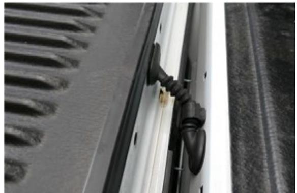
Führen Sie das Kabel durch die original Kabeltülle aus der Heckklappe heraus. Anschließend leiten Sie das Kabel links am Rahmen entlang weiter vor bis zum Tankdeckel Stellmotor.
