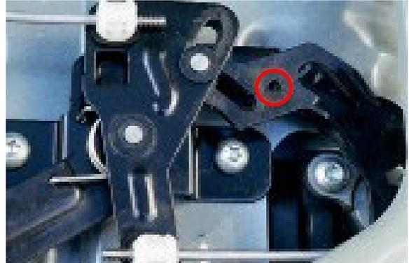
Bohren Sie ein 4 mm Loch in die Mitte des abgebildeten Heckklappenschlosses (siehe rote Markierung auf Abbildung).
