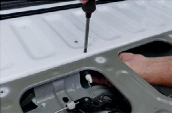
Montieren Sie jetzt den Stellmotor und nutzen Sie dafür die beiliegenden 4 mm Schrauben. Benötigtes Werkzeug: 7 mm Gabelschlüssel und Kreuzschlitzschraubendreher.
