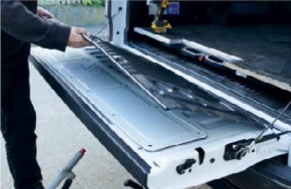
Öffnen Sie die Heckklappe und drehen Sie die Schrauben aus der Kunststoff-Laderaudeckung heraus (diese könnte verklebt sein). Öffnen Sie die Wartungsklappe.
