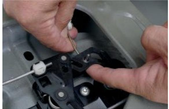
Haken Sie das Gestänge von unten nach oben durch das gebohrte Loch von Abbildung 2 ein und sichern Sie es mit dem beiliegendem Sicherungsclip ab.
