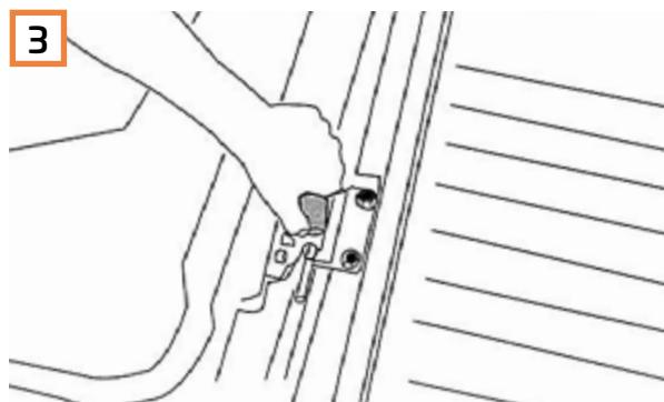
Öffnen Sie die Heckklappe komplett und entnehmen Sie die Gummistopper.
