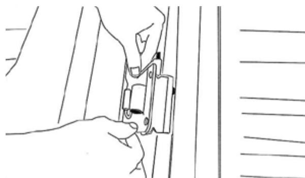
Entfernen Sie das original Heckklappen-Schanier und ersetzen Sie es mit den ProLift Schanieren. Verwenden Sie hierzu die original Schrauben.
