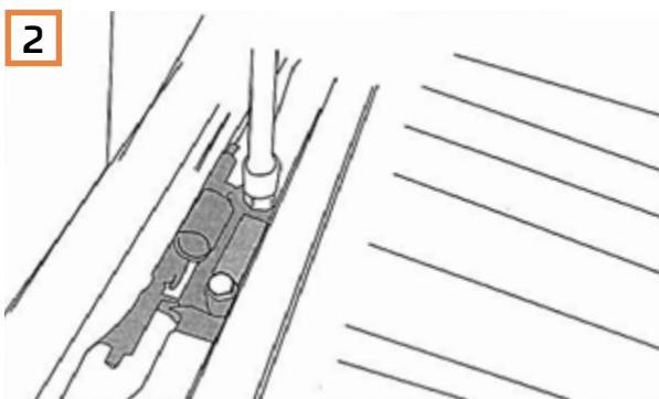
Heben Sie die Heckklappe in die benötigte Position an und befestigen Sie die beiden Schrauben.
