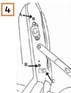
Lösen Sie die Schrauben A und B um die Schlussleuchte zu entfernen sowie den Gummistopper C.
