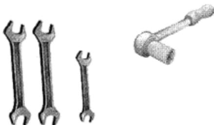
Schraubenschlüssel Nr. 10 und 14, Kreuzschlitz-Schraubendreher, Nuss Nr. 12, 14
