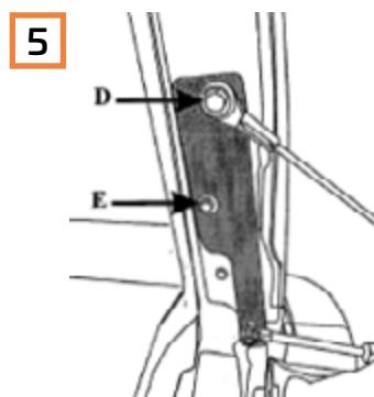
Befestigen Sie den Dämpfer mit dem Untergestell am Fahrzeug mit Hilfe einer M6 Schraube und Mutter siehe Abbildung D & E. Bauen Sie anschließend die Schlussleuchte wieder ein.
