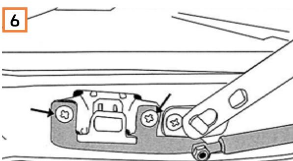
Befestigen Sie den Dämpfer mit den original Schrauben nun auch an der Heckklappe.
