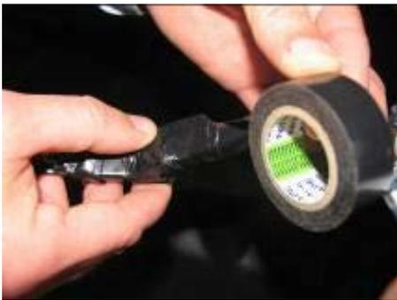
11. Verbinden Sie den Kabelsatz mit dem Kabel des Hardtops, benutzen Sie das Klebeband als Schutz gegen Feuchtigkeit.
