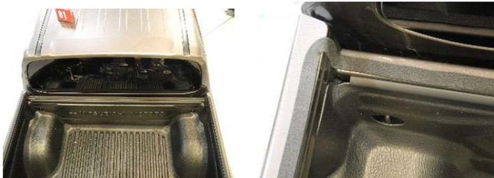
2. Kleben Sie die beiliegende Gummidichtung in einem Stück auf die Ladeflächenoberkante
