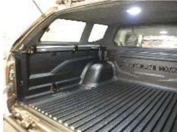
5. Befestigen Sie die Klammern an der Aluminiumleiste und unter der Ladeflächenkante (siehe Abbildung links). Der Anzugsdrehmoment beträgt gleichmäßig **MAX 1 NM**.
