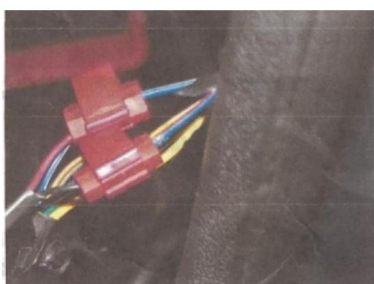
6. Führen Sie das Kabel am Rahmen entlang bis vor unter die linke Fahrertürschwelle
