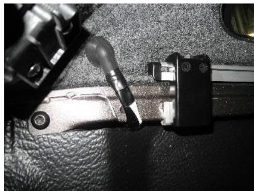
9. Führen Sie das Kabel durch die vorhandene Öffnung.
