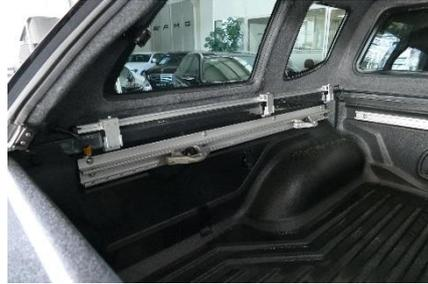
4. Befestigen Sie die Klammern an der Aluminiumleiste und unter der Ladeflächenkante (siehe Abbildung links). Der Anzugsdrehmoment beträgt gleichmäßig **MAX 1 NM**.
