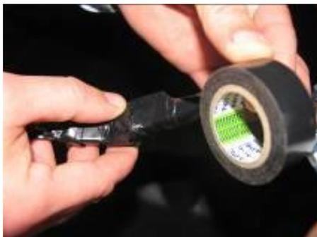
10. Verbinden Sie den Kabelsatz mit dem Kabel des Hardtops, benutzen Sie das Klebeband als Schutz gegen Feuchtigkeit.
