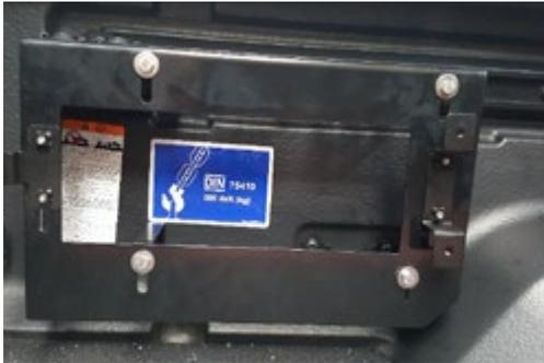
Befestigen Sie die zwei mitgelieferten Halter Nr. 5 und Nr. 6 an der Haltevorrichtung. Verwenden Sie hierfür: M8 x 16, M8 Beilagscheibe, M8 Sicherungsring
