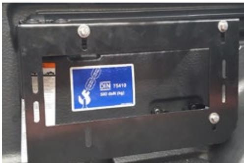
Befestigen Sie die Haltevorrichtung Nr. 2 an die drei Winkel. Verwenden Sie hierfür: M8 x 25 Schrauben, M8 Beilagscheibe, M8 Sicherungsring, M8 Muttern.
