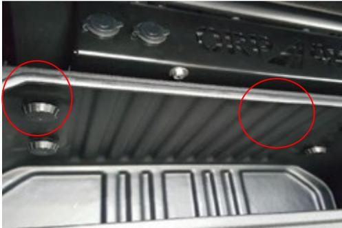
Schrauben Sie die Box nun mit den vier Befestigungsschrauben aus Plastik an die Halterung.
