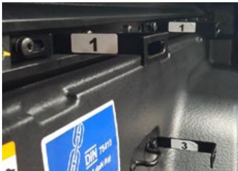
Schrauben Sie die zwei Halterungen Nr. 1 und die Halterung Nr. 3 wie abgebildet mit den Original Schrauben an die Bordwand.
