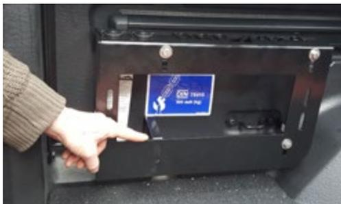
Befestigen Sie die Halterung Nr. 4 wie gezeigt. Verwenden Sie hierfür: M8 x 25, M8 Beilagscheibe, M8 Mutter, M8 Sicherungsring
