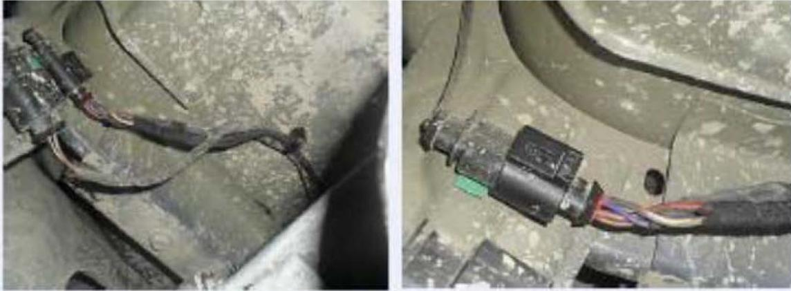
Den Connector finden Sie links vom Tank auf Höhe des Tankeinfüllstutzens.
