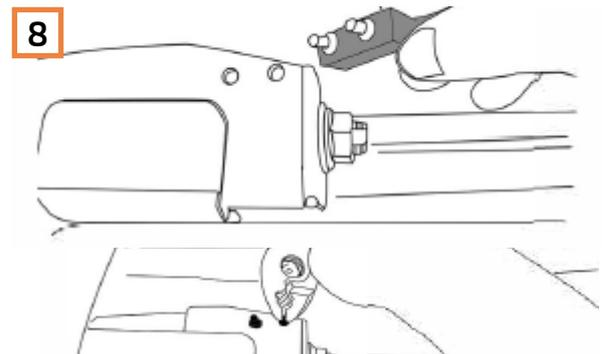
Setzen Sie die zwei Gummistopper in die Scharniere links und rechts. Vorsichtig mit einer Flachzange festziehen.
