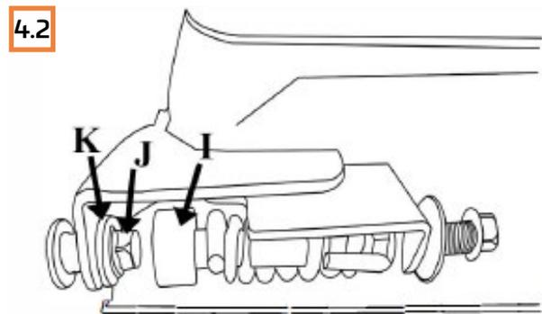
Ziehen Sie die Mutter (E) an, bis die Buchse (I) den Holzkopf (J) vollständig bedeckt und die flache Unterlegscheibe (K) berührt.
