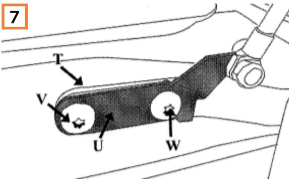
Befestigen Sie den Dämpfer an der Heckklappe, indem Sie die Dämpferhalterung (T) unter der Heckklappen-Schlingenhalterung (U) anbringen und zusammen mit der Originalhalterung (V) festziehen (W)
