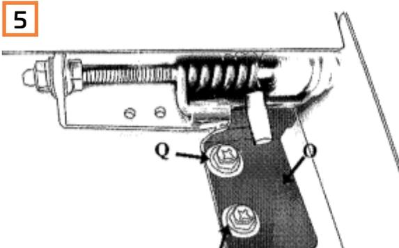
Befestigen Sie nun links und rechts die Federankerbleche (O) mit den Originalschrauben (P). Falls Ihr Pick-up Gummianschlagpuffer besaß, können Sie diese wieder anbringen (Q)
