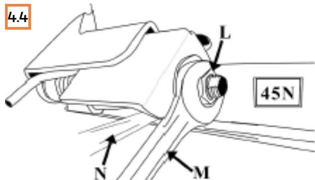
Ziehen Sie die Mutter (L) mit dem Schlüssel Nr. 12 (M) an, während Sie die Mutter (E) mit dem Schlüssel Nr. 12 (N) festhalten.
