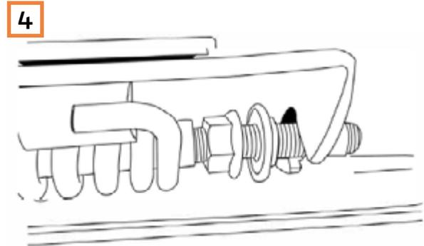
Setzen Sie den Federsatz mit Heckklappenhalterung wie abgebildet ein.
