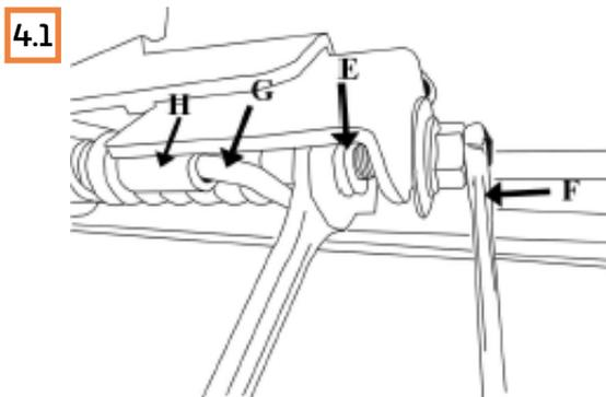
Ziehen Sie die Mutter (E) an, während Sie die Stange des Federsatzes mit dem Schlüssel Nr. 6 (F) festhalten.
