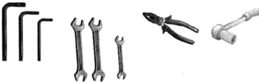
Inbusschlüssel, Schraubenschlüssel Nr. 6 und 12, Zange, Nuss Nr. 12, 17
