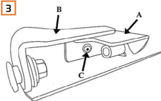
Befestigen Sie die Schiene (A) an der Heckklappenhalterung (B) mit der Originalschraube (C)
