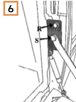
Dämpfer mit Originalschrauben am Pickup befestigen (R) (S)
