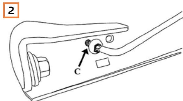
Lösen Sie die abgebildete Schraube (C)
